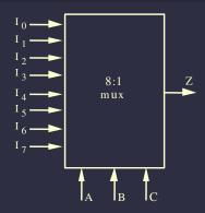
$$Z = \overline{A} \, \overline{B} \, \overline{C} \, I_0 + \overline{A} \, \overline{B} \, C I_1 + \overline{A} \, B \, \overline{C} \, I_2 + \overline{A} \, B C I_3 +$$
